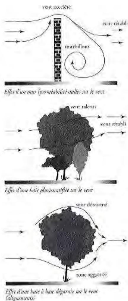
Figure 4 : Effet d'un obstacle sur le vent<sup>5</sup>
